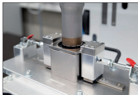
Individuálně navržený pracovní upínací přípravek zaručuje, že je membrána přesně utěsněna ve středu plastového krytu.
