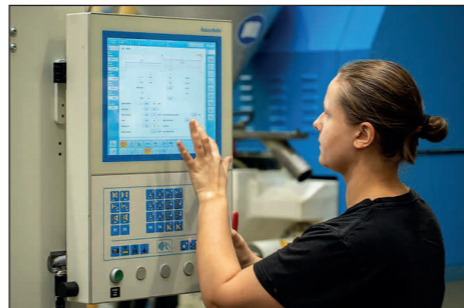
Snadné a intuitivní ovládání: panel řídicího systému MC P1 u nového precisionMolding.
