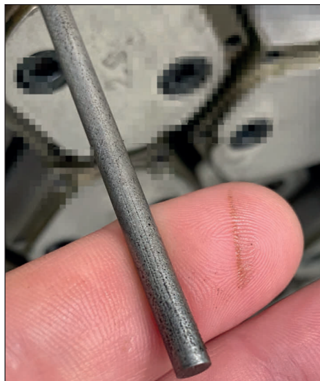
Obrázek 4 Poškozený vyhazovač po cca 15.000 cyklech
