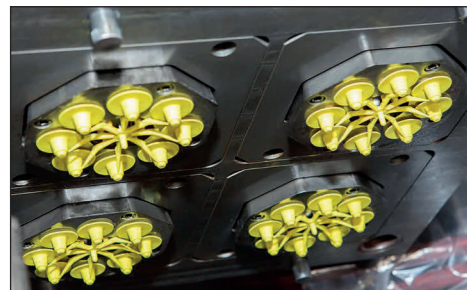
Pohled do nitra formy: Zpracování TPU vyžaduje zvláštní přesnost. Tu u precisionMolding zajišťuje již standardní verze nástroje.
