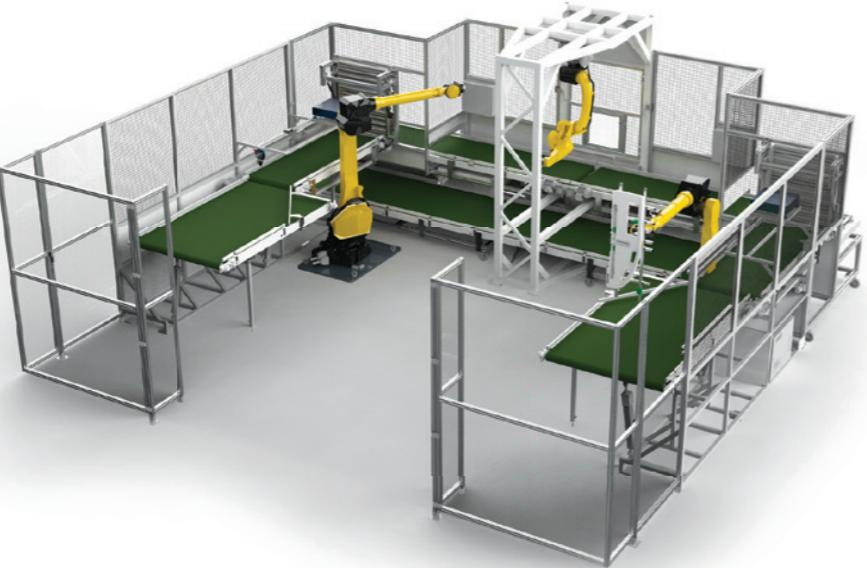
u jednotlivých dílů liší. Firmě **RESIM** se po dlouholetém vývoji podařilo naučit tuto činnost roboty. Zvažovaly se různé možnosti opracování defleše – frézování, ořez laserem, ultrazvukem
