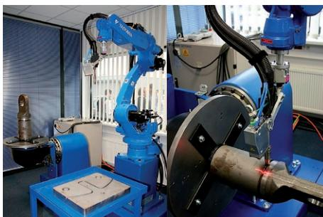
Svařovací robot Motoman s naváděcím systémem Motosence
