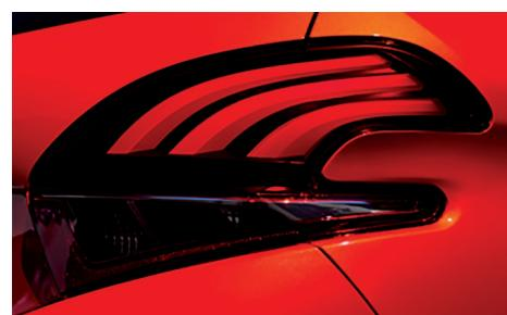
Obr.3. Zadní svítila, u které homogenní vzhled obrysové funkce zajišťuje filtr z difuzního typu PC materiálu
