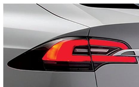
Obr.4. Zadní svítila, jež je uvnitř vybavena odražnými bílými reflektory, které zlepšují homogenost vycházejícího světla.
