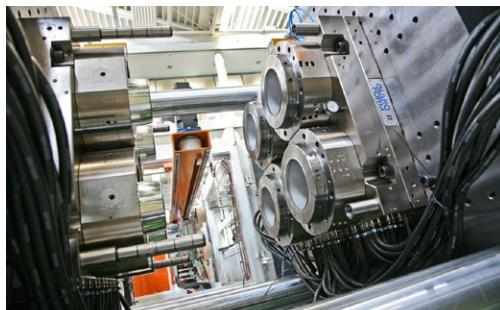
Neustálým přizpůsobováním uzavírací síly software iQ clamp control automaticky udržuje konstantní úroveň dýchání formy i při kolísajících procesních podmínkách.
