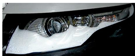
Obr.1. Přední světlomet po kondenzační zkoušce nahoru - bez aplikovaného antifog laku na vnitřní straně "skla", dolu - vnější kryt s antifog lakovem
