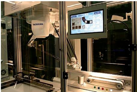
Část balicí linky MPP3 s vysokorychlostním robotem
