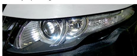
Obr.2. Přední světlomet, kde charakteristické světelné funkce jsou tvořeny pomocí dílů vyrobených z opticky čirých plastů (PC)
