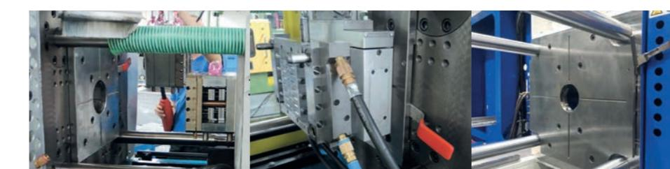
Upnutí formy je obsluhou provedeno během několika sekund pomocí ručního bajonetového zámku bez většího úsilí. Čas potřebný pro pevné uchycení formy je podstatně zkrácen, protože
