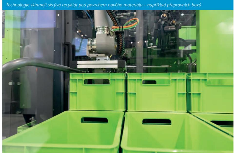
Technologie skinmelt skrývá recyklát pod povrchem nového materiálu – například přepravních boxů
