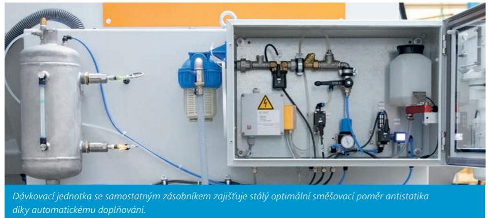
Dávkovací jednotka se samostatným zásobníkem zajistuje stálý optimální směšovací poměr antistatika díky automatickému doplňování.
