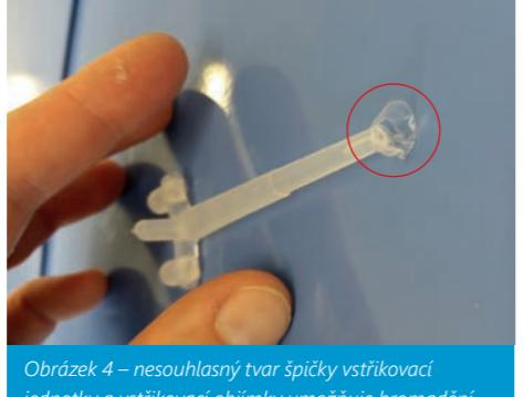
Obrázek 4 - nesouhlasný tvar špičky vstřikovací jednotky a vstřikovací objímkou umožňuje hromadění plastu před špičkou a následně únik materiálu směrem na topení vstřikovací jednotky
