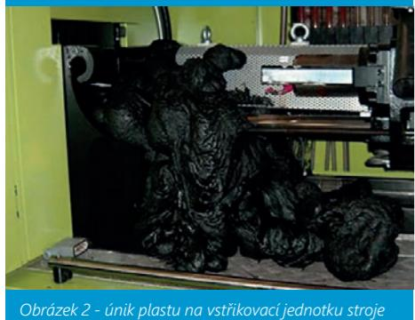
Obrázek 2 - únik plastu na vstřikovací jednotku stroje
