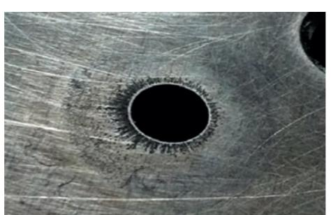
Obrázek 5 - chemická koroze zničila těsnící plochu na rozváděcí desce
