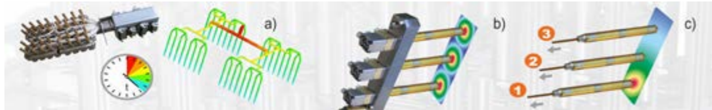
a) Přirozeně vyvážený systém horkých vtoků s 32 uzavíratelnými tryškami | b) Při otevření všech trysek horkého vtoku zároveň dojde ke vzniku studených spojů c) Díky sekvenčnímu vstříkávání lze průběžně plnit výlisk bez studených spojů
