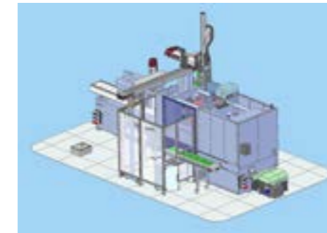
SmartPower 240 XL s automatizovanou stanicí na výrobu dotykových panelů
