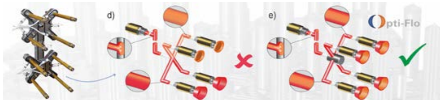
d) Potenciální scénář v 8 násobném systému horkých vtoků – v důsledku rozdělení toku taveniny s asymetrickým smykovým profilem se v rozváděcí desce vytvářejí rozvětvení s různými úrovněmi viskozity – vnější dutiny jsou tedy v tomto případě plněny nejdříve oranžová: nižší smyk, červená: vyšší smyk e) Pomocí rozváděcí desky Opti-Flo® s vložkou pro otáčení taveniny je dosažováno symetrického smykového profilu v každém rozvětvení, takže všechny dutiny jsou plněny rovnoměrně.
