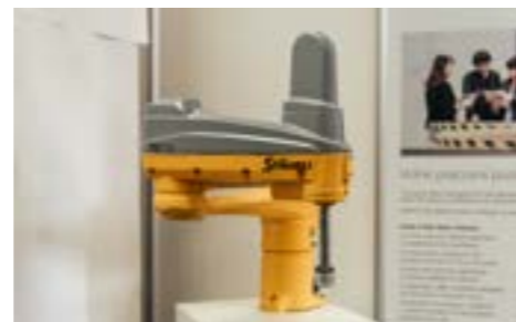
člena TS2-100. Za zmínku stojí unikátní převodovku JCS, kterou již můžete znát z šestiosých TX2 a je klíčová pro výrazné navýšení výkonu.
